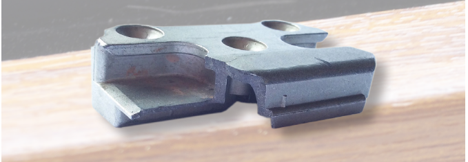
Ein Original-Fensterbeschlag, der einem Einbruch nicht stand hielt. Die Pilzkopfzapfen waren hier wirkungslos.
